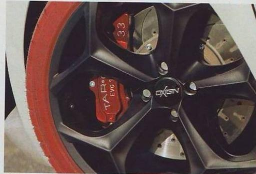
10 pistons pour chaque étrier avant, sur des disques de 330 mm!
