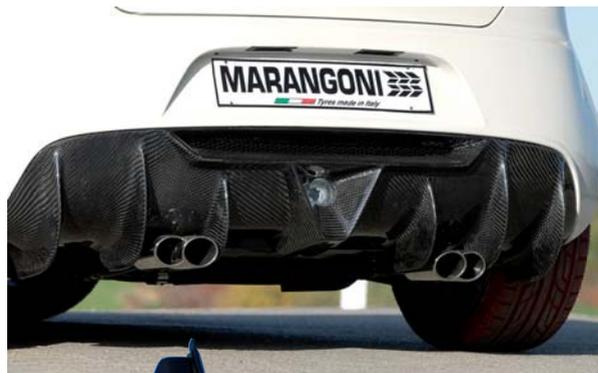
Il diffusore posteriore, con luce di retromarcia incorporata, è in carbonio e in perfetto stile Ferrari F430. A lato, le cerniere LSD che permettono l'apertura delle porte ad ali di gabbiano.
