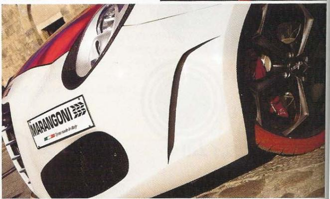
↑足元はKW製ロワリングシステムで40mmロワリングさせた。制動装置もアップグレード。Tarox製B33 10ポットキャリパー&330×26ディスクを組み合わせたブレーキシステムに変更
